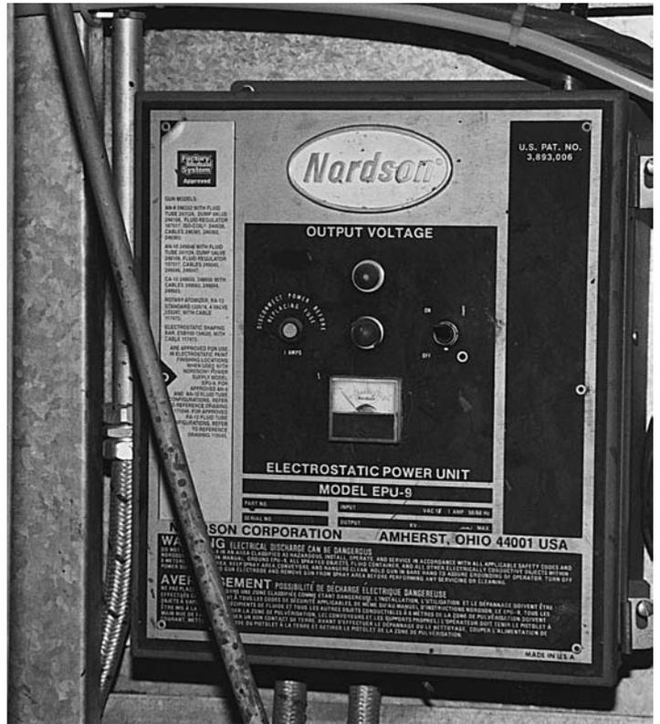
Fig. 9 - Generatore elettrostatico
